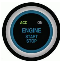
Modré podsvícení aktivní Po prvním stisknutí svítí ACC – výstup pro ACC aktivní
